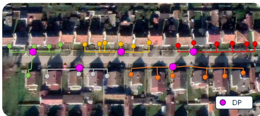
Slika 21 - Primjer veza između zgrada i izvoda (DP) kod bakrene mreže (Izvor: Axon)
